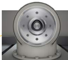
O sistema de ferramentas Coromant Capto® é diretamente integrado ao fuso.
